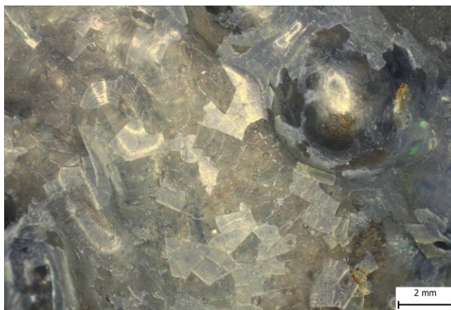
Obrázek 3: Korozní poškození ve formě jemných vrstviček dehydratovaného \text{SiO}_2 .
