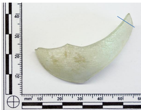
Obrázek 2: Označené místo odběru vzorku C1 k SEM/EDS
