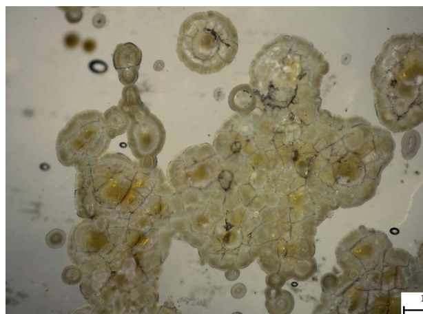
Obrázek 3: OM vzorku C5, důlková koroze do hloubky cca 100 µm
