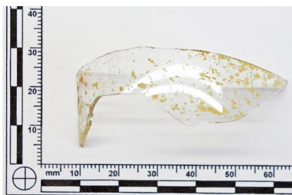
Obrázek 2: Označené místo odběru vzorku C5 k SEM/EDS
